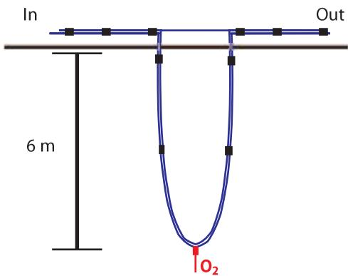
Иллюстрация 2.14: Кислородный конус и оксигенатор шахтного типа (Waterflow: Течение воды; In: Приток; Out: Отток; 6 м: 6 м).
