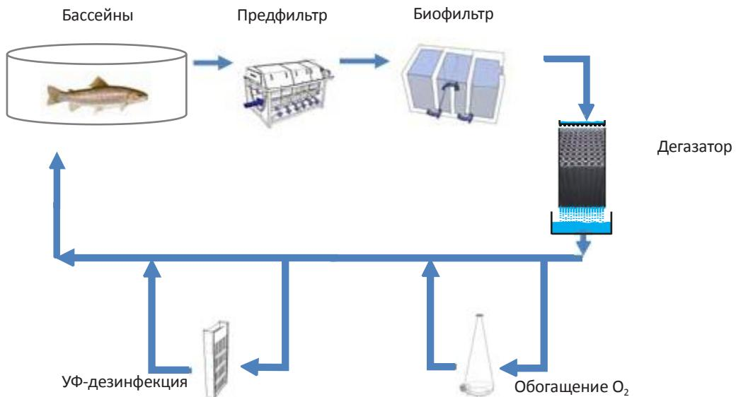
Иллюстрация 2.1 Изображение принципа УЗВ. Основная система очистки воды состоит из механической фильтрации, биологической очистки и аэрации/дегазации. В зависимости от потребностей можно также добавить другие установки, например, для обогащения кислородом или УФ-дезинфекции.
