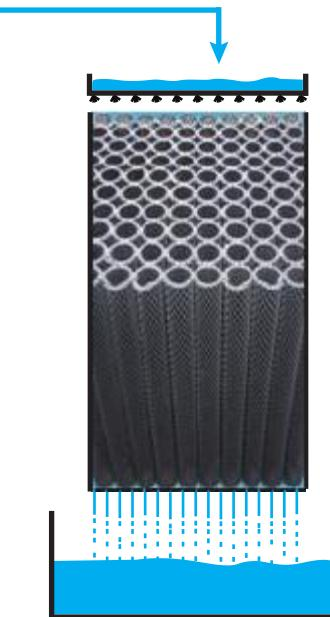
Иллюстрация 2.13 Фотография капельного фильтра, обернутого синей пластмассовой пленкой для избежания брызг на полу. Такой процесс аэрации/зачистки также называют процессом CO<sub>2</sub>-зачистки. Как правило, заполнитель в капельном фильтре обычно бывает того же самого типа, который используется в биофильтрах с неподвижным заполнителем – см. иллюстрацию 2.10.
