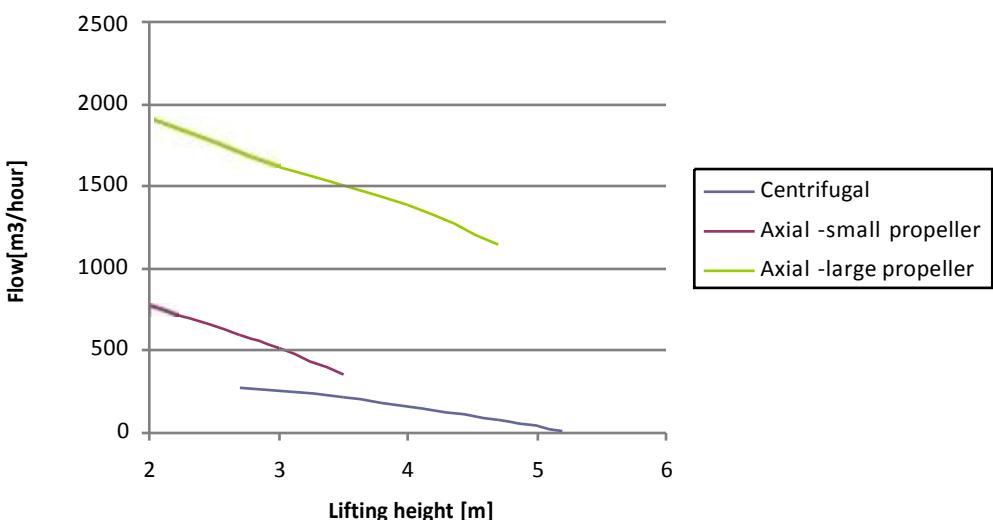
Иллюстрация 2.17 Пример, показывающий использование различных типов насосов. Насосы высокого давления (центробежные насосы) используются для подачи меньших объемов воды на большую высоту, а насосы низкого давления (осевые насосы) – для подачи больших объемов воды на меньшую высоту. (Flow [m³/hour]: Расход [м³/час]; Lifting height [m]: Высота подачи [м]; Centrifugal: Центробежный; Axial – small propeller: Осевой с малым пропеллером; Axial – large propeller: Осевой с большим пропеллером)
