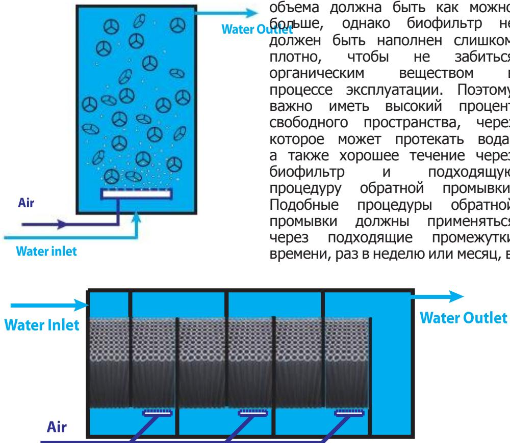
Иллюстрация 2.11 Биофильтры с плавающей и неподвижной загрузкой. (Air: Воздух; Water inlet: Водозabor; Water outlet: Водосток)
