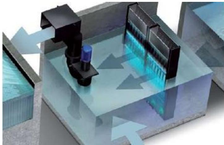
Иллюстрация 2.15 Система для УФ-обработки.
